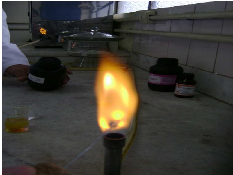
Figura 3 – Teste de Chama – Sódio (chama amarelada)
