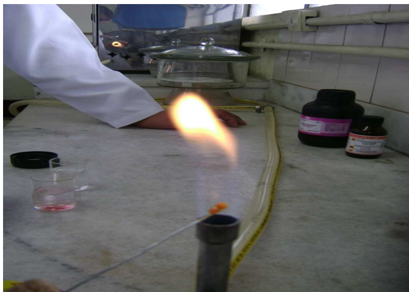
Figura 4 – Teste de Chama – Potássio (chama violeta)
